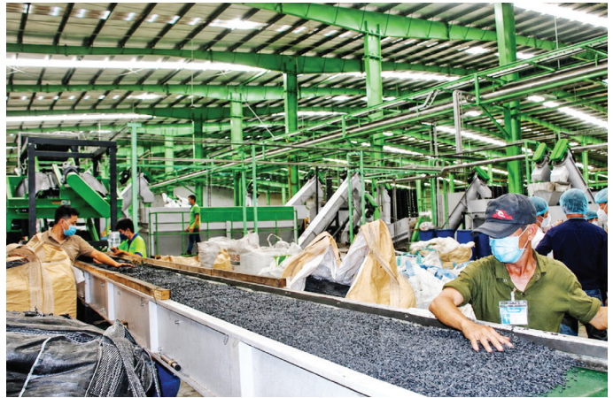
Dây chuyền tái chế hạt nhựa HDPE tại Nhà máy Number One Hậu Giang
