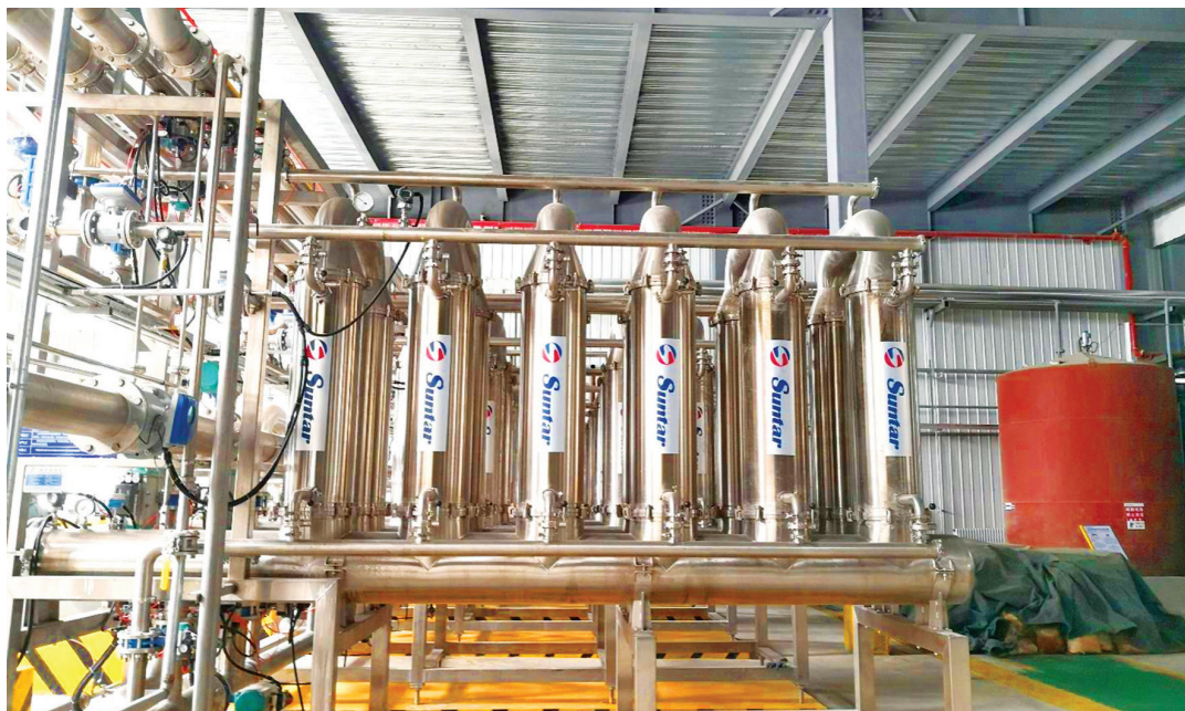
Hệ thống màng Suntar hoạt động trong dây chuyền sản xuất đồ uống.
