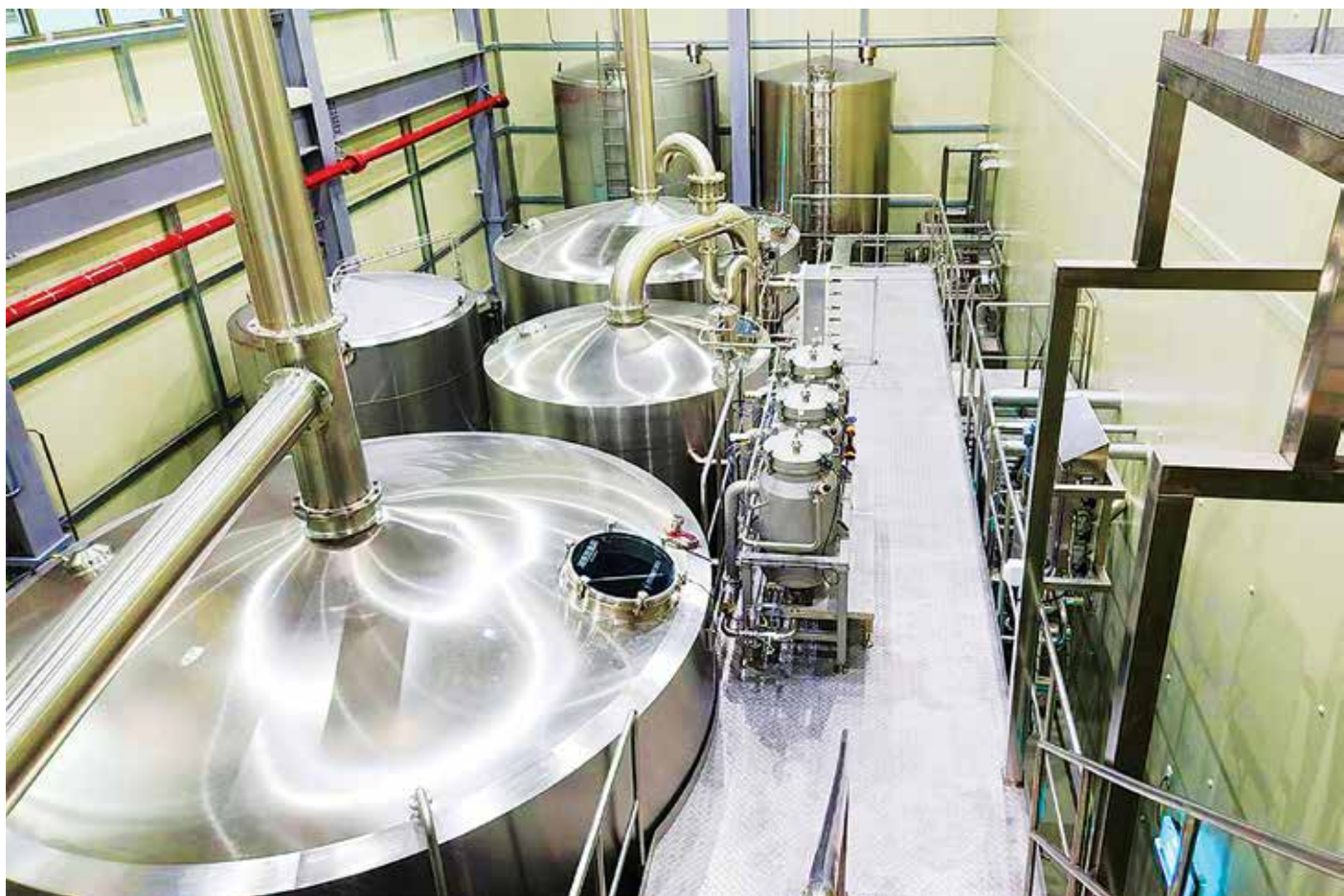
Mô hình nấu bia theo mô-đun CombiCube đặc biệt lý tưởng cho các nhà sản xuất bia thủ công, do họ thường yêu cầu các quy trình nấu bia và dung tích mẻ nấu linh hoạt trong khi không gian thường bị hạn chế (Nguồn hình ảnh: Sevenbräu)
